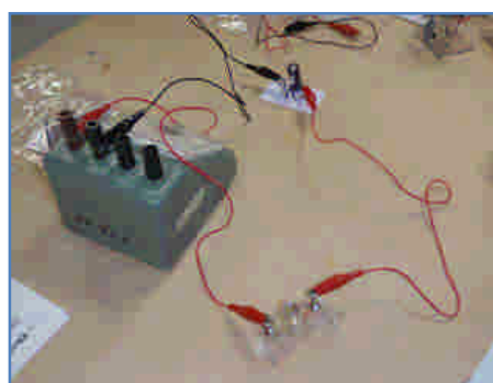
図 3 コンデンサーと電流計、豆電球をつなぎ、回路を作る。
