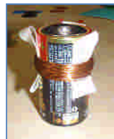
図1 電池にエナメル線を巻きつける
