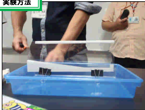
①バットを準備し、バットの中に堆積実験装置を立たせる。
