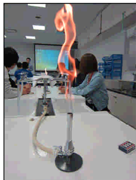
図2 もし火を消さずにバーナーを待機させる場合は、青い炎のままではなく赤い炎にしときましょう。これにより視覚的に火が消えていないことがわかります。
